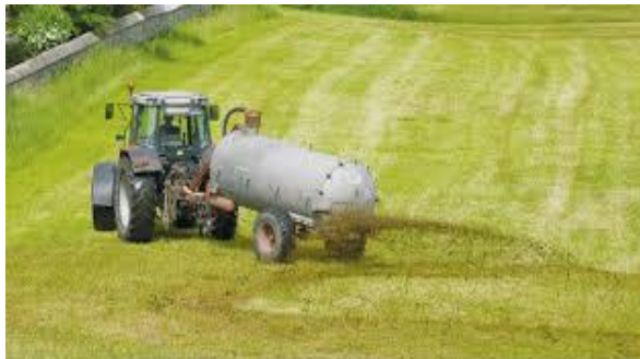
Wóz asenizacyjny z systemem płóz (nawożenie pasmowe)
