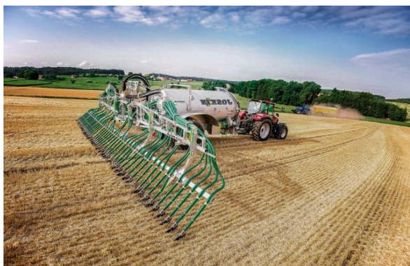
Wóz asenizacyjny z systemem płóz (nawożenie pasmowe)
